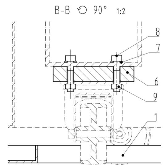
Die Tropfwanne gemäß Zeichnung ist ausgelegt für die Aufstellung der Grundmaschine einschließlich Späneförderer. Für Reinigungsanlage, Werkstoffnachschub und weitere Anbaugeräte sind bei Bedarf weitere Tropfwannen nötig. Nicht berücksichtigt sind individuelle Gegebenheiten, wie z.B. Breite der Umfassung der Maschine, eingelegter Lauffrost, Platzverhältnisse sowie die Aufstellung externer Ausrüstungskomponenten wie z.B. Werkstückhandhabung, etc.
